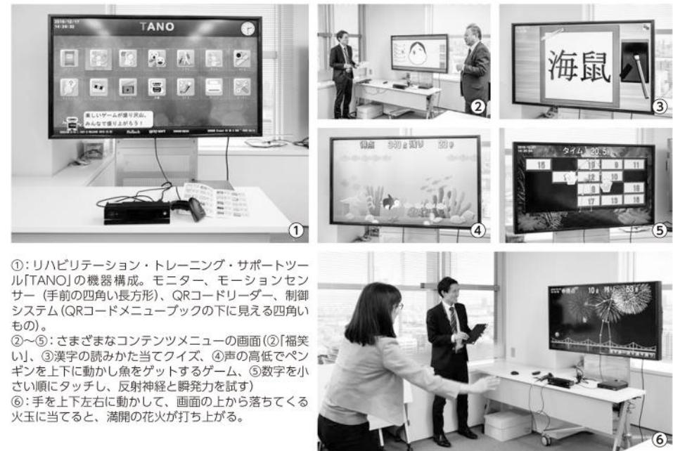
①:リハビリテーション・トレーニング・サポートツール「TANO」の機器構成。モニター、モーションセンサー（手前の四角い長方形）、QRコードリーダー、制御システム（QRコードメニュー／ブックの下に見える四角いもの）。
